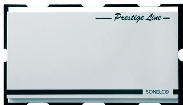
Amplificador monofónico de 8W/2 Ohm para montar en caja de empotrar P4901. Permite realizar varias combinaciones de altavoces ó baffles pasivos con diversas potencias por punto de sonido. Se pueden conectar desde 1 hasta 8 altavoces ó baffles. Los altavoces ó baffles se conectan en paralelo al amplificador, en la regleta prevista para ello. El nivel sonoro del amplificador puede regularse mediante el potenciómetro de ajuste de sensibilidad.
